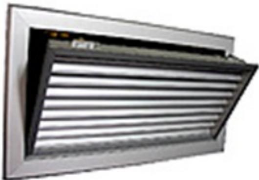
Алуминиумска решетка за потис или одсис на воздух која може да се постави на сид или плафон со еден ред фиксни ламели под агол од  $45^{\circ}$ , паралелни со првата дадена димензија. Со дампер за регулација на протокот на воздух, можност за отворање и со вграден филтер за воздух.
