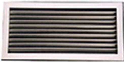
Алуминиумска решетка за потис или одсис на воздух која може да се постави на сид или плафон со еден ред фиксни ламели под агол од  $45^{\circ}$ , паралелни со првата дадена димензија. Со дампер за регулација на протокот на воздух и со вграден филтер за воздух.
