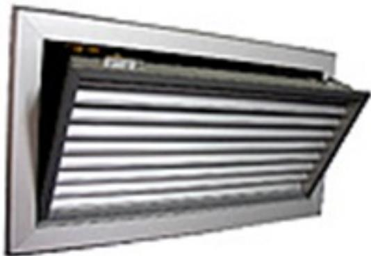
Алуминиумска решетка за потис или одсис на воздух која може да се постави на ѕид или плафон со еден ред фиксни ламели под агол од  $45^\circ$ , паралелни со првата дадена димензија. Со можност за отворање.
