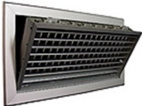
Алуминиумска решетка за потис или одсис на воздух која може да се постави на сид или плафон со два реда подвижни ламели за насочување на воздухот паралелни со првата дадена димензија. Со дампер за регулација на протокот на воздух, можност за отворање и со вграден филтер за воздух.
