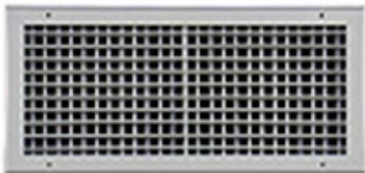
Алуминиумска решетка за потис или одсис на воздух која може да се постави на сид или плафон со два реда подвижни ламели за насочување на воздухот паралелни со првата дадена димензија. Со дампер за регулација на протокот на воздух и со вграден филтер за воздух.
