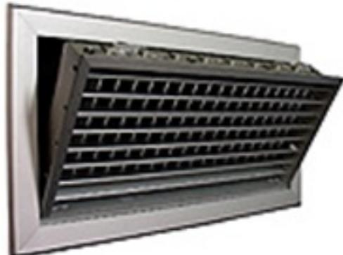
Алуминиумска решетка за потис или одсис на воздух која може да се постави на сид или плафон со два реда подвижни ламели за насочување на воздухот паралелни со првата дадена димензија. Со дампер за регулација на протокот на воздух и со можност за отворање.
