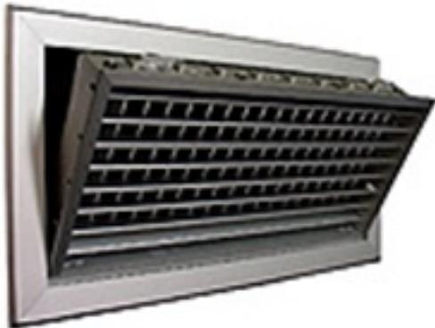
Алуминиумска решетка за потис или одсис на воздух која може да се постави на ѕид или плафон со два реда подвижни ламели за насочување на воздухот паралелни со првата дадена димензија. Со можност за отворање.
