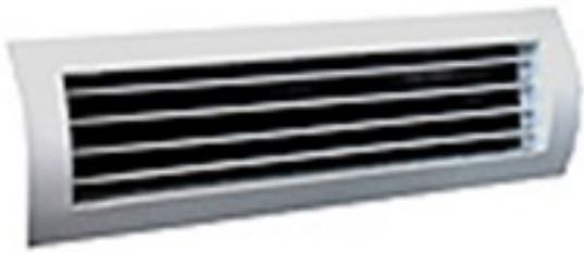
Алуминиумска решетка за потис или одсис на воздух која може да се постави на кружен канал (спиро канал), со еден ред подвижни ламели за насочување на воздухот паралелни со првата дадена димензија.
